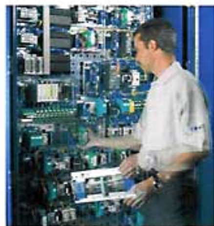
Bild 3. Die Moduibaueise erlaubt ein schnelles Austauschen im Reparaturfall
