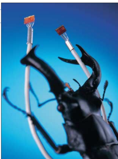
Bild 3: Endoskopie-Hybridleitung mit Anschlussplatine (und Käfer als Größenvergleich).
