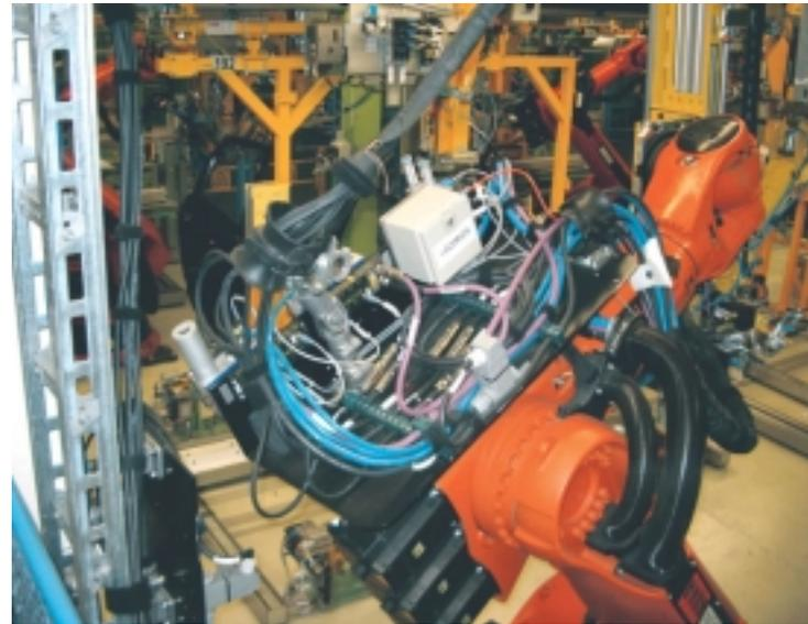
Roboter beim Werkzeugwechsel - ohne Werkzeug
