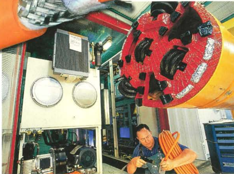
Bild 3: Montage der Hybrid-Leitungen für die Maschinen des Typs Micro. Diese Leitungen kommen auch beim Verlegen von Pipelines zum Einsatz.
