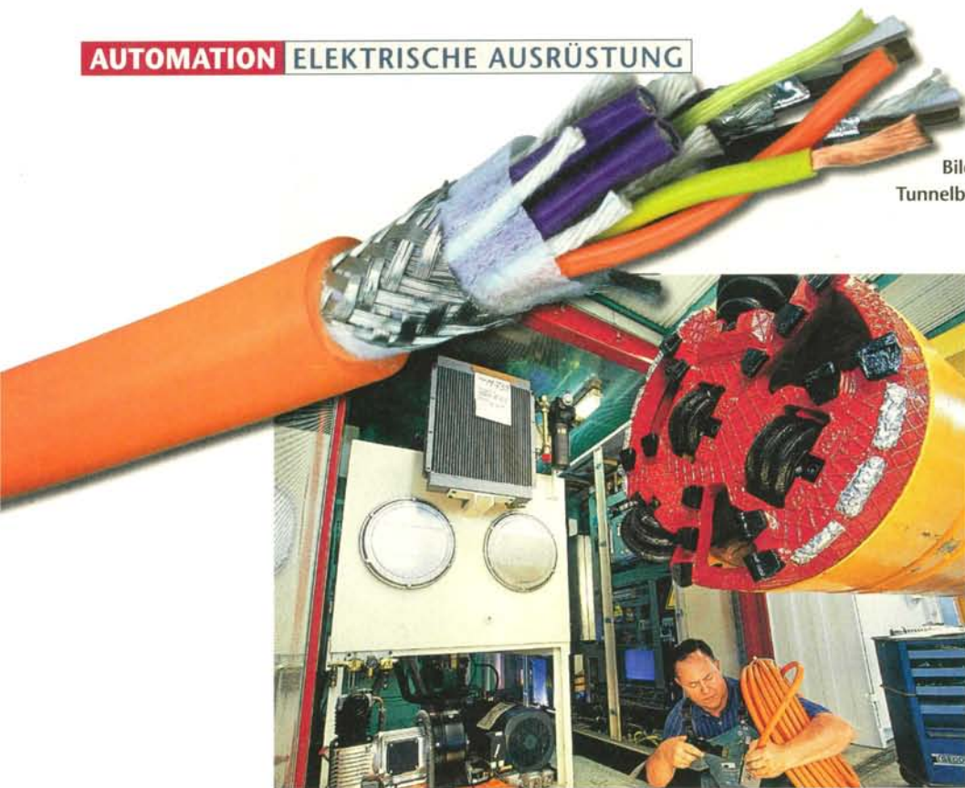
Bild 3: Montage der Hybrid-Leitungen für die Maschinen des Typs Micro. Diese Leitungen kommen auch beim Verlegen von Pipelines zum Einsatz.
