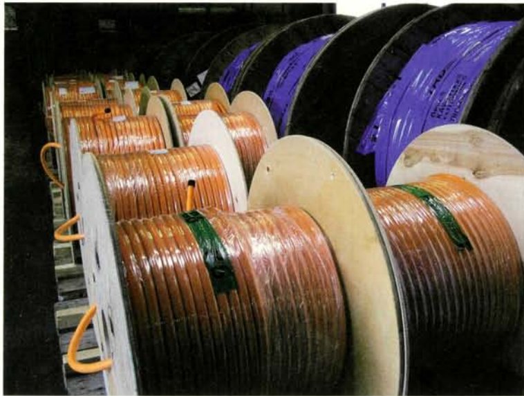
Bild 1: Passend abgelängt werden die TKD-Kabel direkt zu Herrenknecht geliefert.
