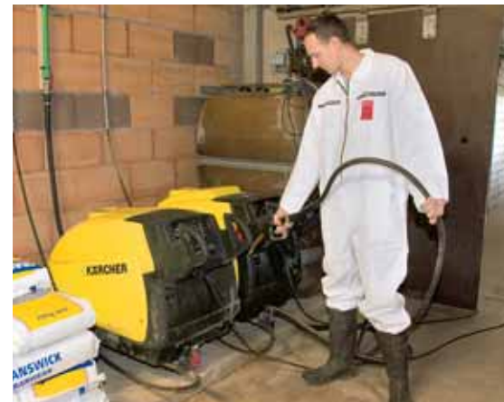
Die eigentlich mobilen Hochdruckgeräte werden in Lichtenau stationär genutzt.
