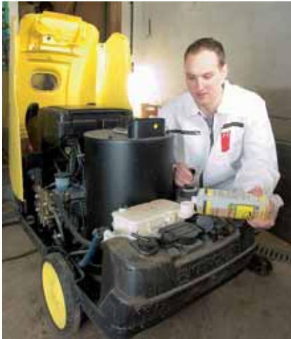
Zur Wartung der Hochdruckreiniger gehört das Nachfüllen des Wasserenthärterers.
