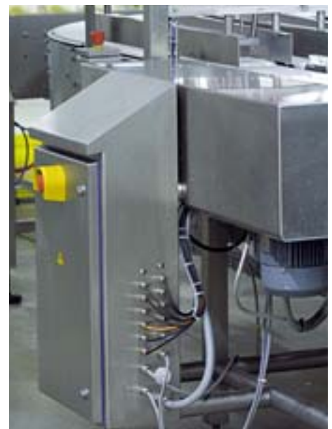
Mittelgroßes HD-Gehäuse an der Siegelmaschine der Tray-Linie
