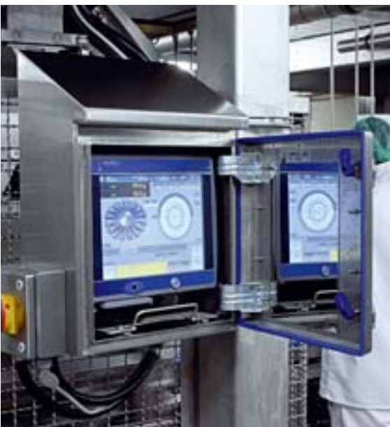
Mit Spiegel: Ein kleines HD-Gehäuse schützt als reine Umhausung ein Touchscreen-Panel
