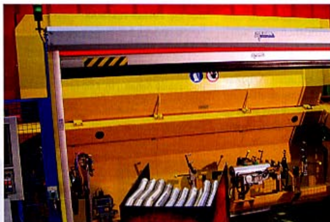
Am Start: Frontansicht einer der drei Schweißzellen mit kooperierenden Robotern, in denen bei DaimlerChrysler in Düsseldorf Abgasstränge gefertigt werden
